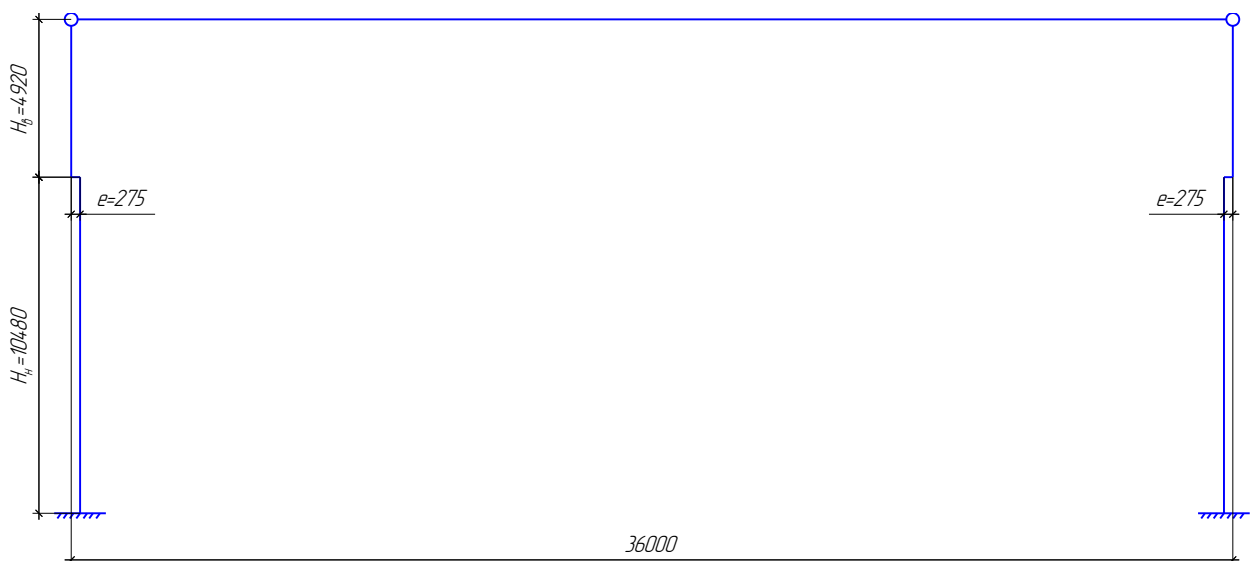
Рисунок 3. Расчетная схема поперечной рамы
